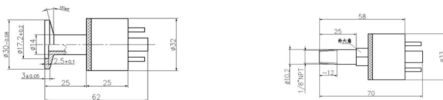
直插式规管可插入橡皮管（内径 12mm 的真空橡皮管）或金属真空规管接头组件；DNKF16 快卸式金属规，可用快速连接卡箍（带中心 O 型橡胶密封圈）连接，美标螺纹接口式规管可直接螺纹连接，三种连接件的加工图纸可致电上海云捷真空 021-62315744、62317134 索取。标准发货是 DNKF16 快卸式金属规再加上不锈钢 DNKF16 转Φ 15mm 转接头及带中心 O 型橡胶密封圈快速卡箍。
